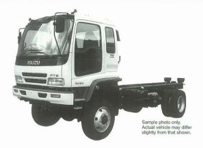
6HK1-TCC Power 169kW @ 2400rpm Torque 686 Nm @ 1500rpm
